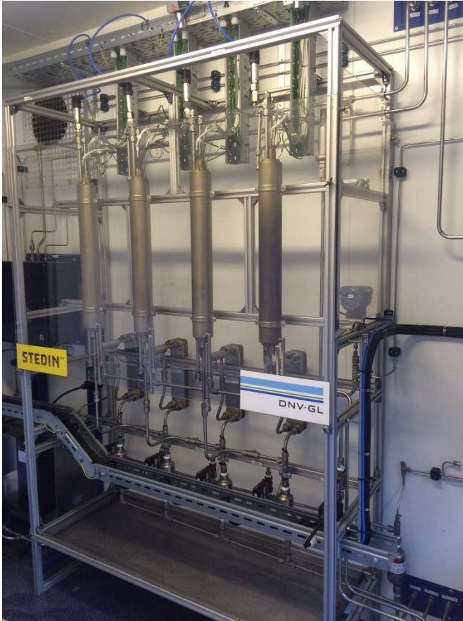
Figuur 21 Methaniseringsproces in vier in serie geschakelde reactorvaten (eigen opname)
