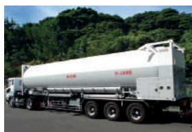
Tankwagen dubbelwandig vloeibaar H 2 , (Kawasaki, JPN)
