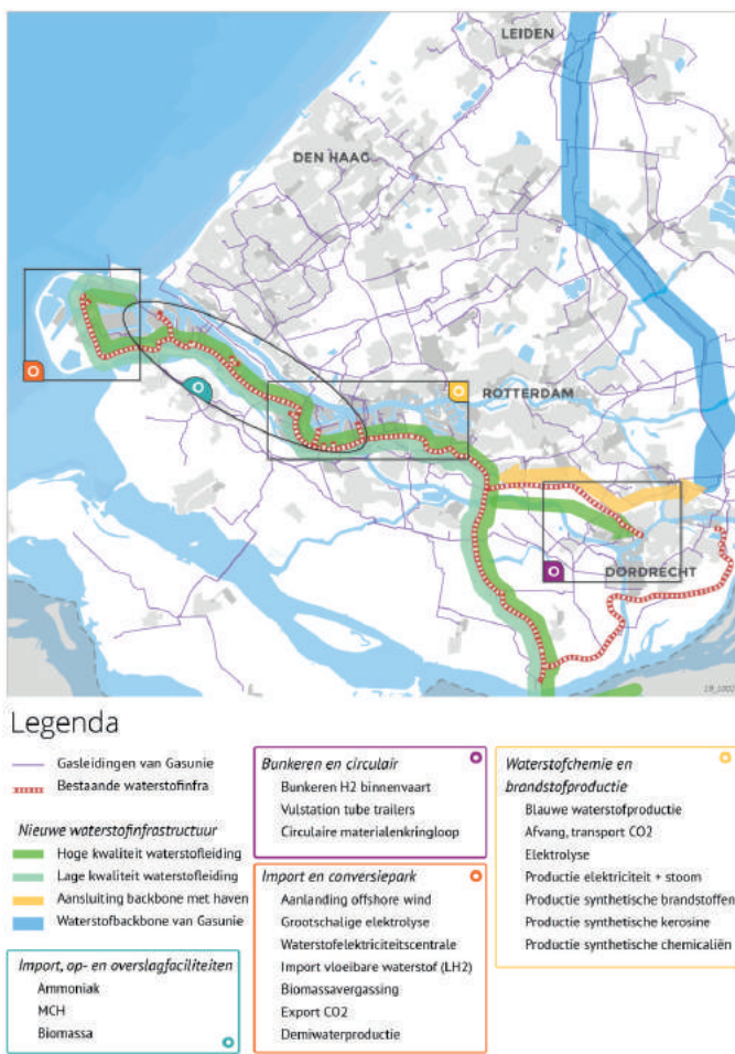
Figuur 4: Beoogde ontwikkeling waterstoffaciliteiten in Rotterdamse haven met het Haven Industrieel Complex (uit groene waterstofvisie Zuid-Holland) 2
