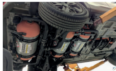
Figuur 38: Waterstofbrandstoftanks Hyundai Nexo en Toyota Mirai
